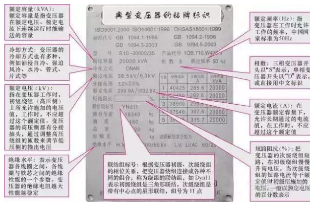
图 1-10 变压器铭牌上的技术参数标识
