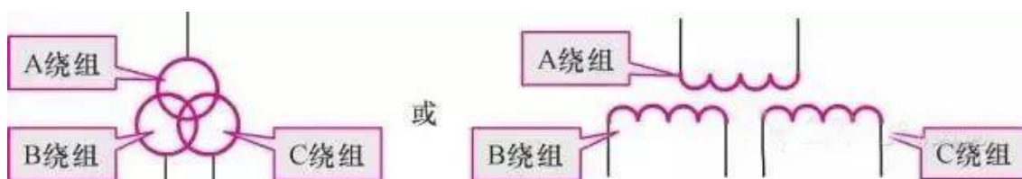
图 1-14 三绕组变压器的图形符号
